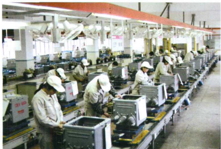
户外配电开关生产流水线
