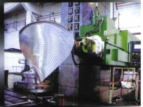
五轴联动数控铣镗床加工水轮机转轮叶片
