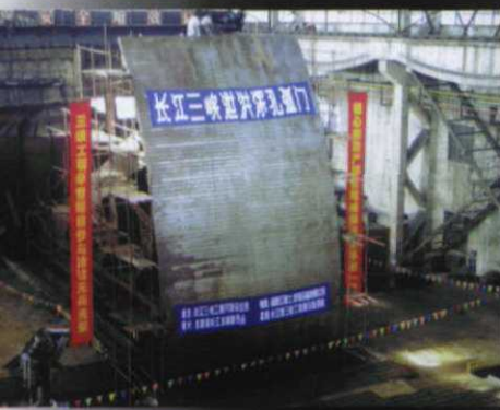
公司承制的长江三峡泄洪深孔弧门厂内预装
