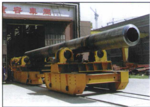
北京巴威公司承制的出口“澳大利亚”的425MW超临界锅炉重要部件—P91集箱
