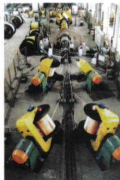
从奥地利引进的大型生 产设备——三米成缆机
