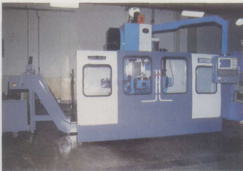
天津第一机床总厂生产的 XH715GY型五轴联动高档叶轮数 控加工中心,代表我国目前机电一 体化数控机床最高水平
