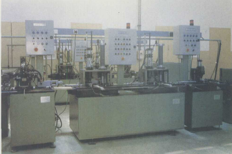
长江机床厂生产的 YJ-ZX1 全自动密封轴承装配后工序生产 线
