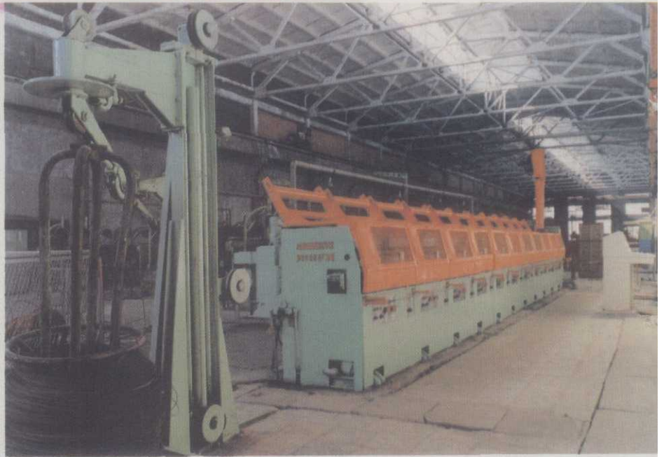
冶金工业部金属制品研究院设计、西安拉拔设备厂制造的 LH 1 -11/360 高速拉丝机，获 1992 年度冶金工业部科技进步奖
