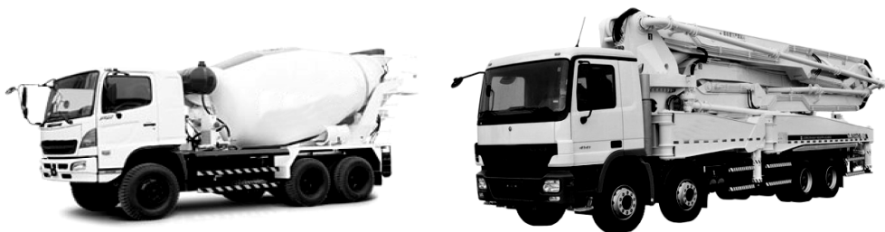
图 1-1 混凝土搅拌输送车和混凝土泵车
