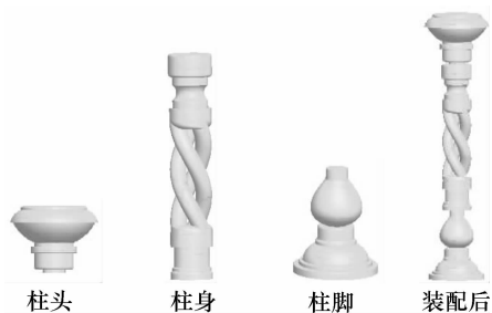
图 1-5 石柱装配实例
