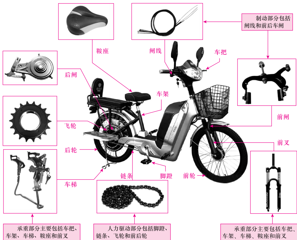
图 1-1 电动自行车机械系统的结构组成
