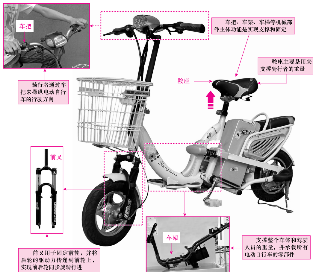
图 1-2 电动自行车的承重部分
