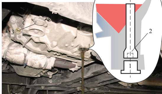
AL4 放油加油检查
