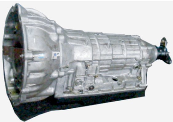
图 1-1-2 A761E 自动变速器整体外形
