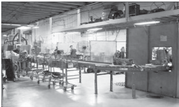
图 1-5 流水线操作的旧件拆解和清洗
