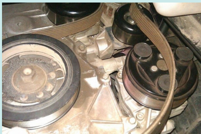
图 1-11 拆卸发动机驱动带
