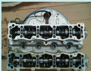
图 1-2 拆卸缸盖总成
