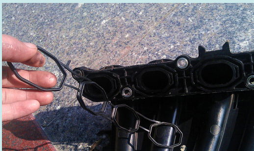
图 1-20 安装新进气歧管衬垫
