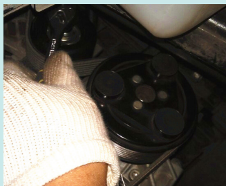
图 1-13 转动自动张紧器安装驱动带
