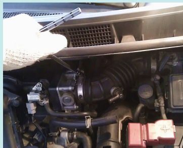
图 1-23 拆下节气门体紧固卡箍
