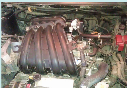
图 1-21 安装进气歧管相关部件
