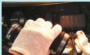
图 1-24 拆下损坏的进气软管
