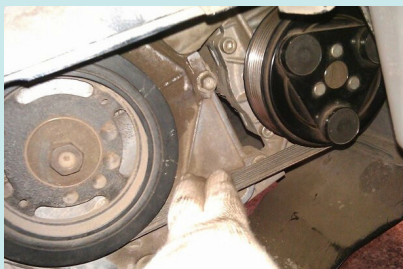
图 1-14 检查发动机驱动带预紧力
