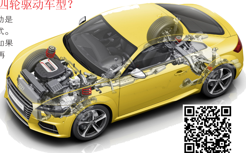
前横置发动机四轮驱动车型构造图
