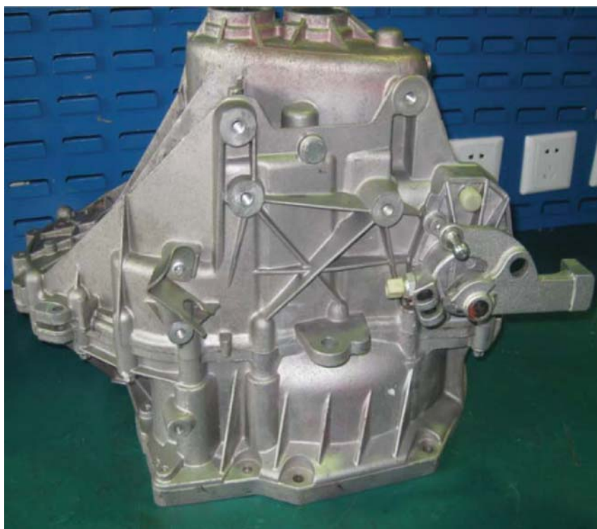
图 8-37 变速器壳体外壁加强筋的分布情况
