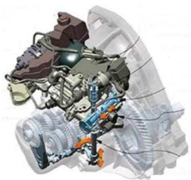
图 6-2 马瑞利电液 AMT 变速器
