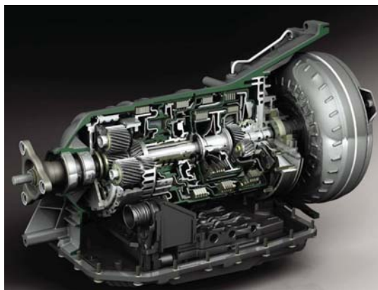
图 3-1 8 速液力式自动变速器 (图片来源: 采埃孚公司)
