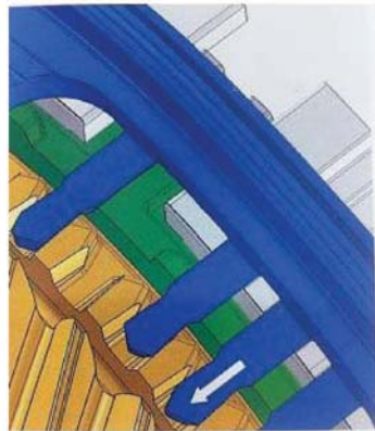
f) 阶段6: 接合套和接合花键接合完毕
