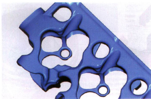
图 4.6-10 乘用车柴油发动机气缸盖水套围绕喷油器处具有精益设计的环形水套 [G35]
