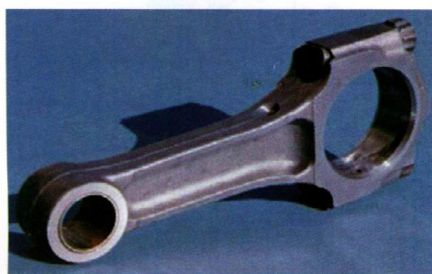
图 4.1-1 连杆的主要尺寸(上): 直切口连杆(左, 乘用车用)及斜切口(右, 商用车用), 引自文献 [C12]; 涨断式连杆(中)(出处: Corus Engineering Steels, Rotherham S60 1DW UK); 传统的工字形截面连杆与赛车上转 90^\circ 方向的工字形截面连杆(出处: Carillo Industries, San Clemente, CA(USA))
