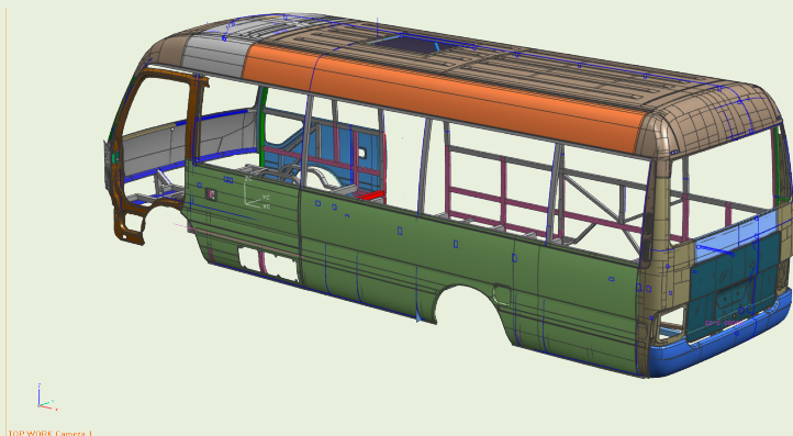
图 1-3 钣金和骨架复合式车身
