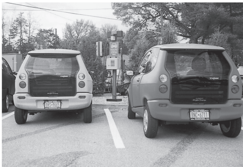
图2 TH!NK 城市电动轿车在查帕奎火车站利用 AVCON 充电桩进行充电
