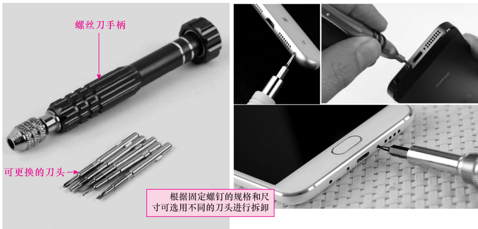
图 1-1 智能手机拆卸用螺丝刀的功能与应用
