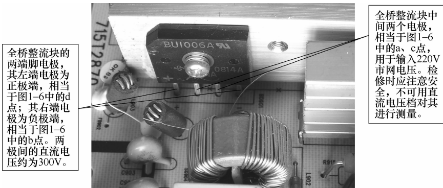
图 1-7 全桥整流块实物组装图
