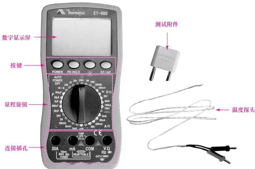
图 1-8 数字式万用表的结构
