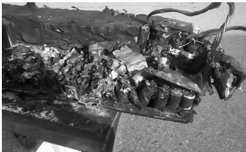
图 1.4 灭火后的图 1.3 中的电池
