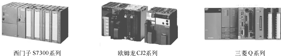
图 1-2 模块式 PLC 示例
