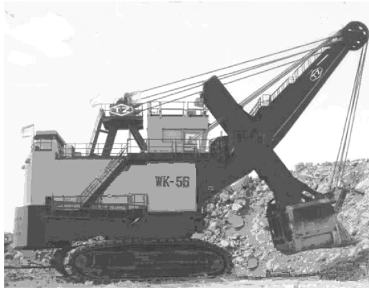
铲斗容积 56\text{m}^3 ，有效载荷 10\text{t} ，整机净重 1265\text{t}
