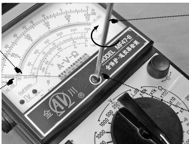
图 1-4 指针式万用表的表头校正螺钉
