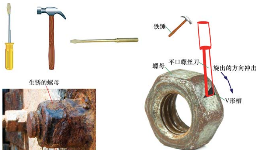
图 1-3 冲击法工具与操作示意
