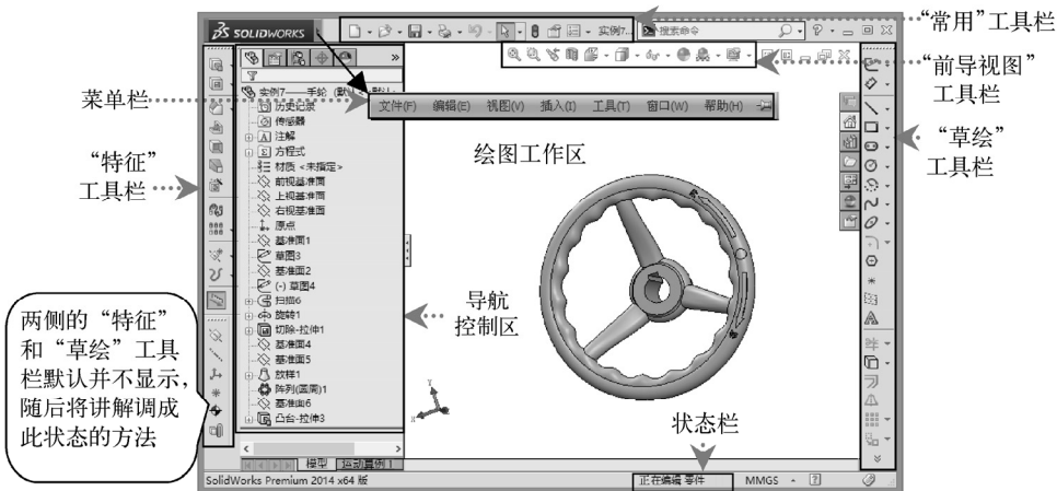
图 1-4 SolidWorks 2014 零件图工作界面
