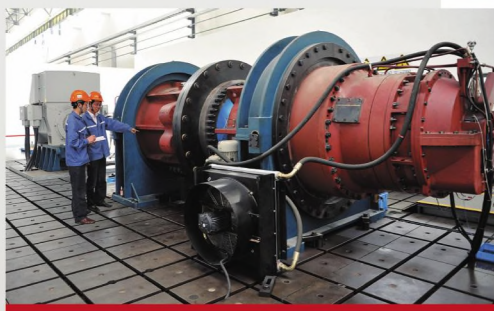
▲ 风电齿轮箱综合试验台
