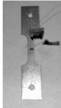
图 2-4 试样上热电偶焊接位置
