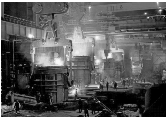
图 1-5 大型模锻压机活动横梁中梁浇注现场
