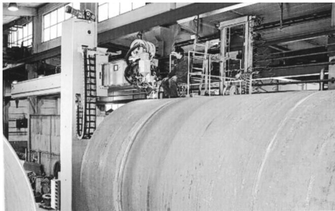
图 1-6 压力容器全自动埋弧焊装备的全貌
