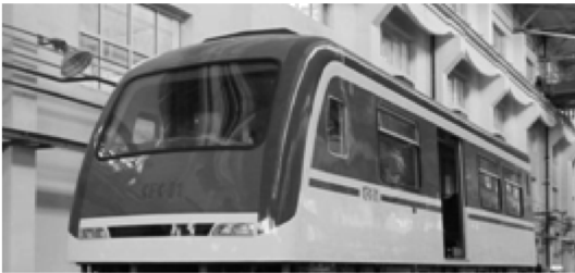
图 1-10 第一台板梁结构铝合金车体
