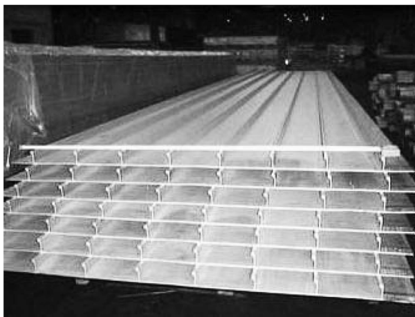
图 1-7 采用 FSW 技术制造的船用中空铝合金型材
