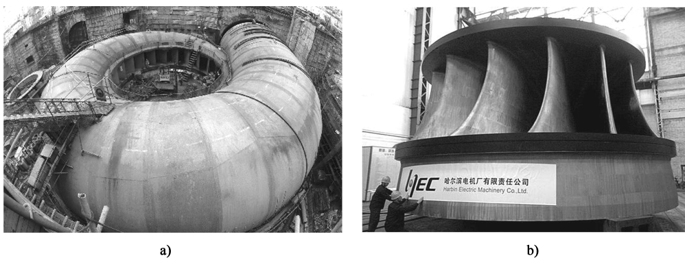
图 1-8 三峡水轮机蜗壳与转轮
