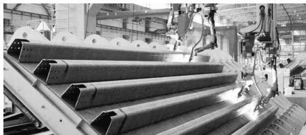
图 1-30 U 形肋板自动焊接
