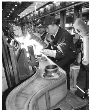
图 1-25 动车转向架半自动 MAG 焊
