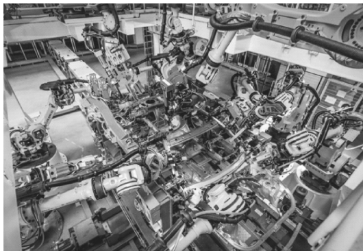
图 1-4 汽车铝合金车身的机器人电阻点焊
