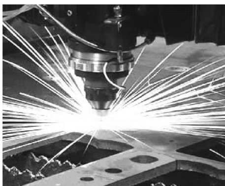
图 1-19 CO 2 激光器（5kW）切割 8mm 厚钢板
