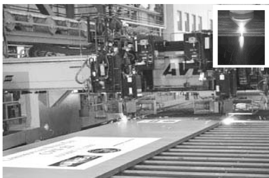
图 1-15 美航母 CVN21 甲板料 (厚度为 70mm) 的数控等离子弧切割 (伊萨)
