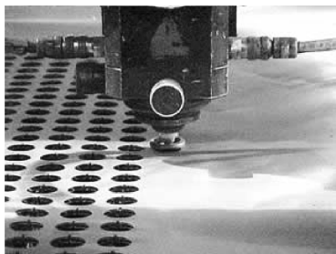
图 1-21 激光切割薄板变形小
