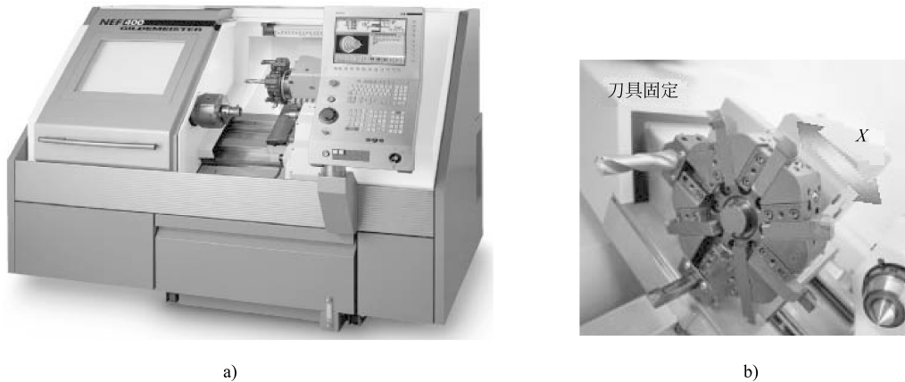
图 1.2-2 全功能数控车床 a) 外形 b) 刀架
