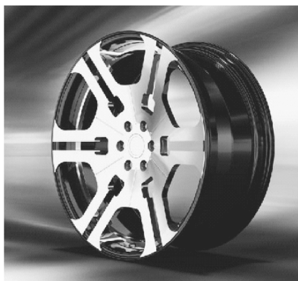
图 1-11 二片式车轮示例
