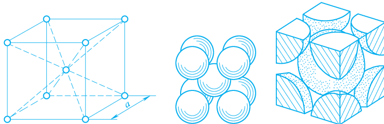
图 1-5 体心立方晶胞示意图
