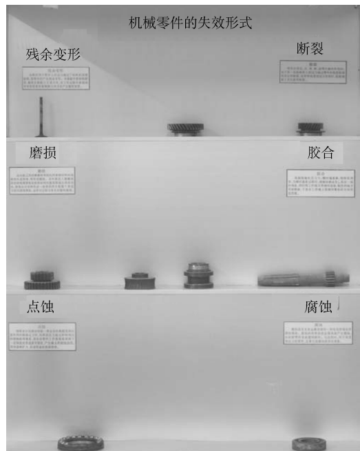
图 1-10 机械零件的失效形式展柜
