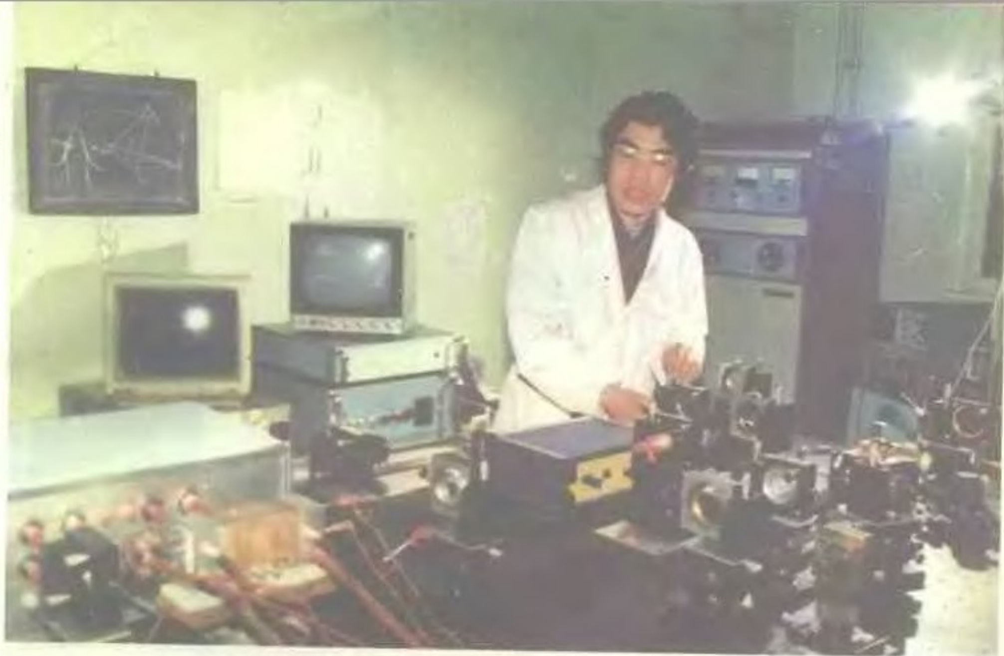
△ 中国科学院西安光学精密机械研究所常增虎博士 在做微微秒锁模激光脉冲实验
