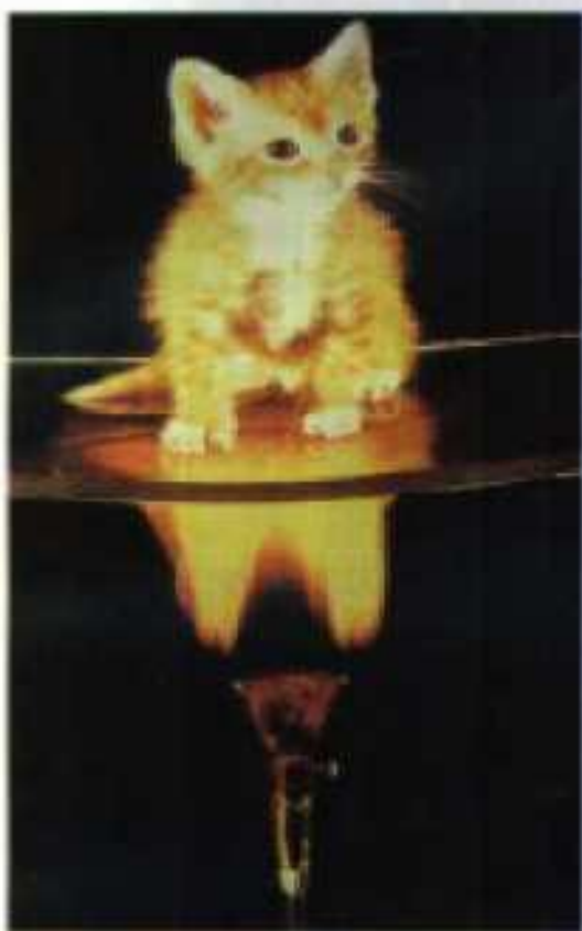
架在 340^{\circ}\text{C} 的火焰上， 抗高温塑料使猫仍然安然无 恙
