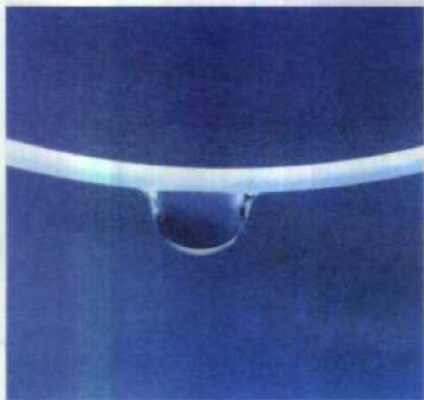
高分子中空纤维具有非常高的过滤功能, 这种材料可用于人工器官
