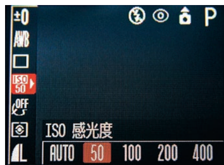
▲ 这是一台家用数码相机的感光度设置从 50 到 400，调整起来很方便
