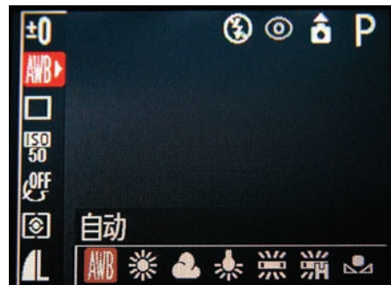
▲ 这是一台家用数码相机的白平衡设置，可以适应不同的色温
