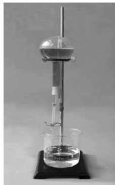
图 1-6 氨溶于水的喷泉实验
