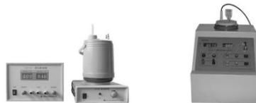
图1 微机测定中和热实验装置
