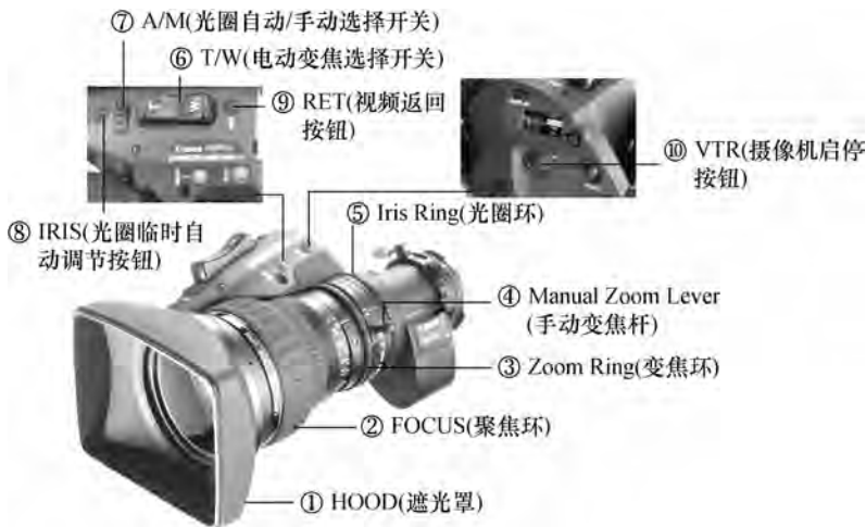
图 1-9 镜头的构成
