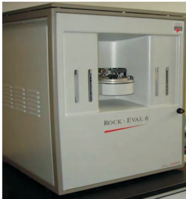
图 3-1 Rock Eval 6 岩石热解仪
