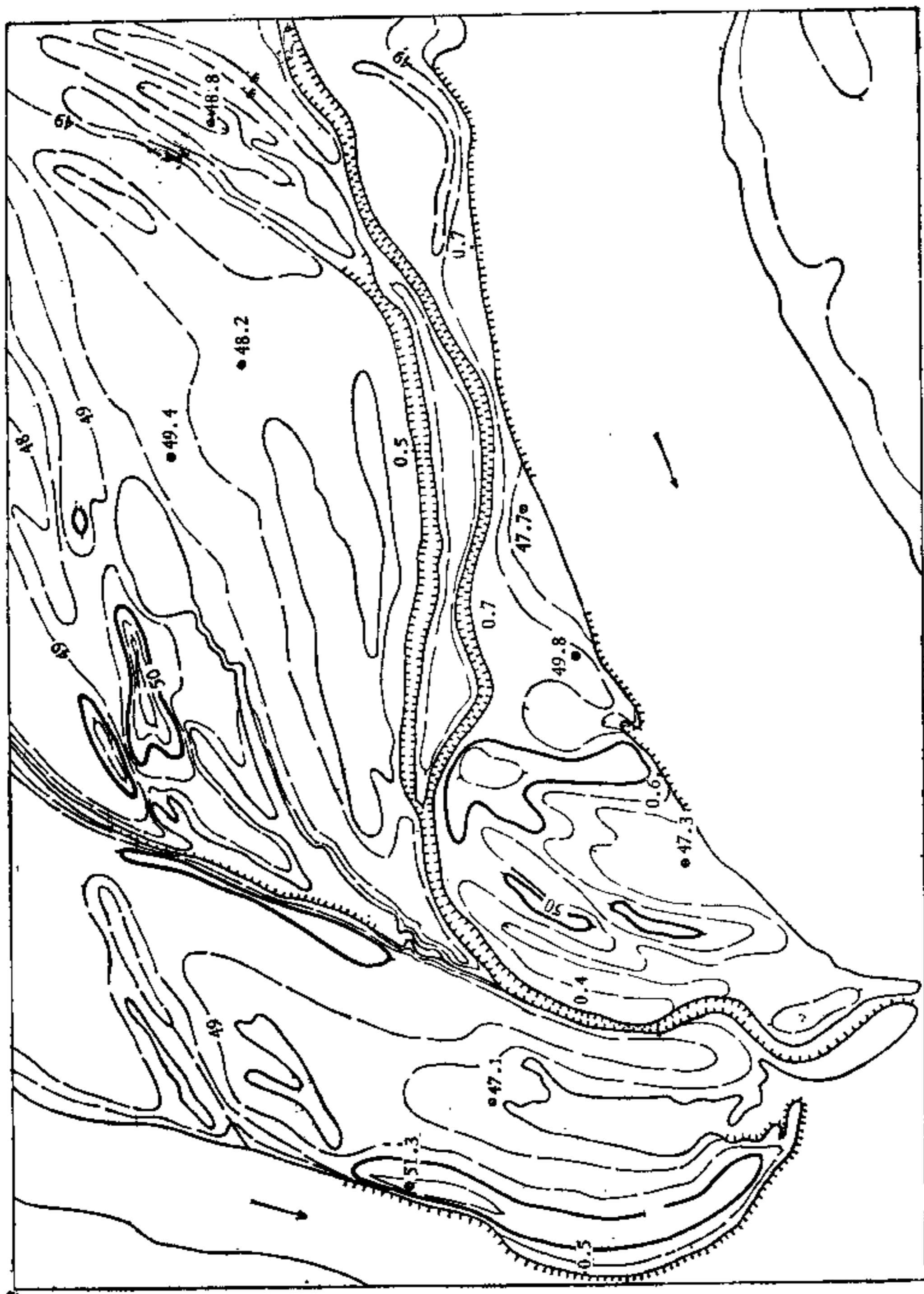
图 1-6 辅助等高线在河漫滩地貌中的应用 比例尺 1:25000 等高距 5 米
