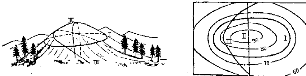
图 2-15 水平岩层(I)、直立岩层(II)和倾斜岩层(III)的空间状态及其在平面图上的表现
