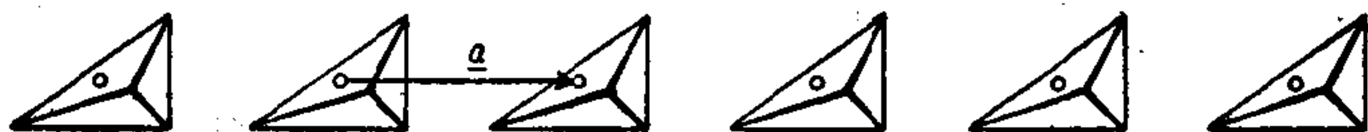
圖 2-1. 直綫点陣結構的示意图。
