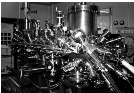
图 1-4 分子束外延装置
