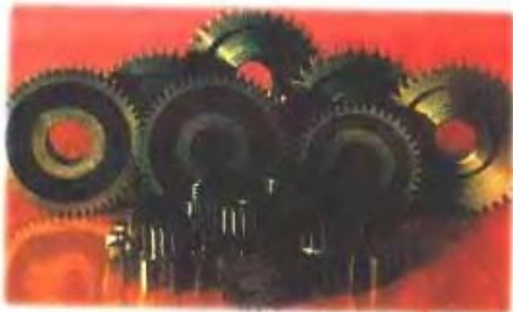
重庆大学分获国家发明二等奖的齿轮零件新制造法(在 CO_2 和平面 CO_2 激光熔铸)(石上)
