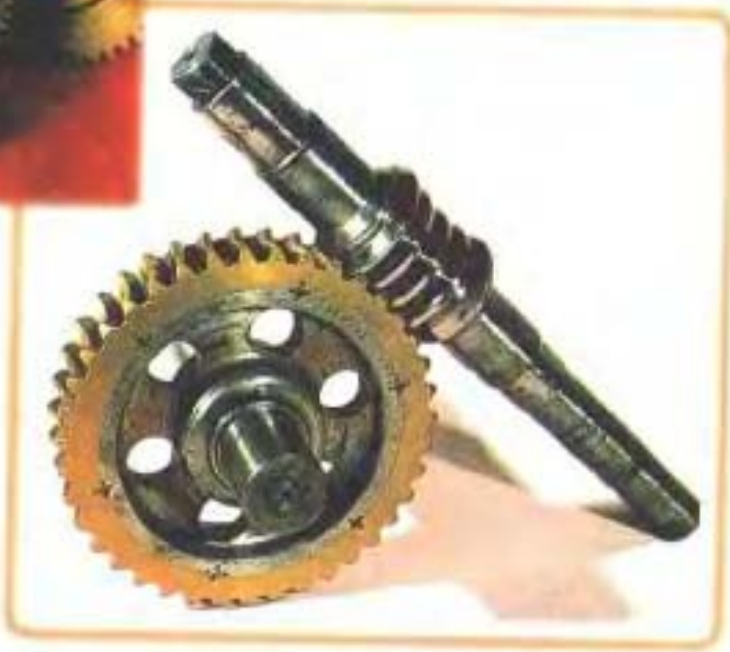
重庆大学分获国家发明二等奖的齿轮零件新制造法(在 CO_2 和平面 CO_2 激光熔铸)(石上)
