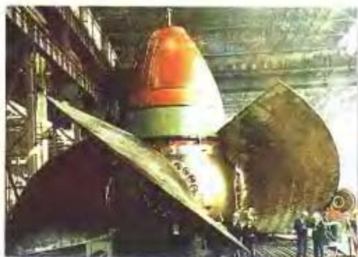
东方电机厂研制的目前 世界上尺寸最大的轴流式 水轮机——额定170MW机 组投产发电仪式。获1985年 国家科技进步特等奖
